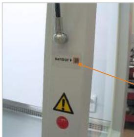
Положение подвижных и съемных деталей, влияющих на защитные свойства бокса, контролируется высокочувствительными оптическими датчиками
